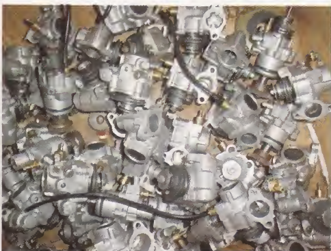
Conjunto de bombas de lubricación
